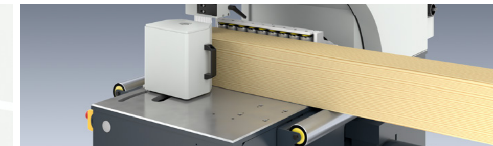
Auflagerolle: erleichtert die Zuführung besonders bei langen, schweren Werkstücken
