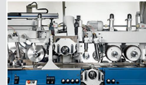
Короткое расстояние между вальцами подачи (1200 мм) и большой диаметр подающих вальцов (250 мм) позволяет обрабатывать короткие детали с высокой степенью стабильности.
