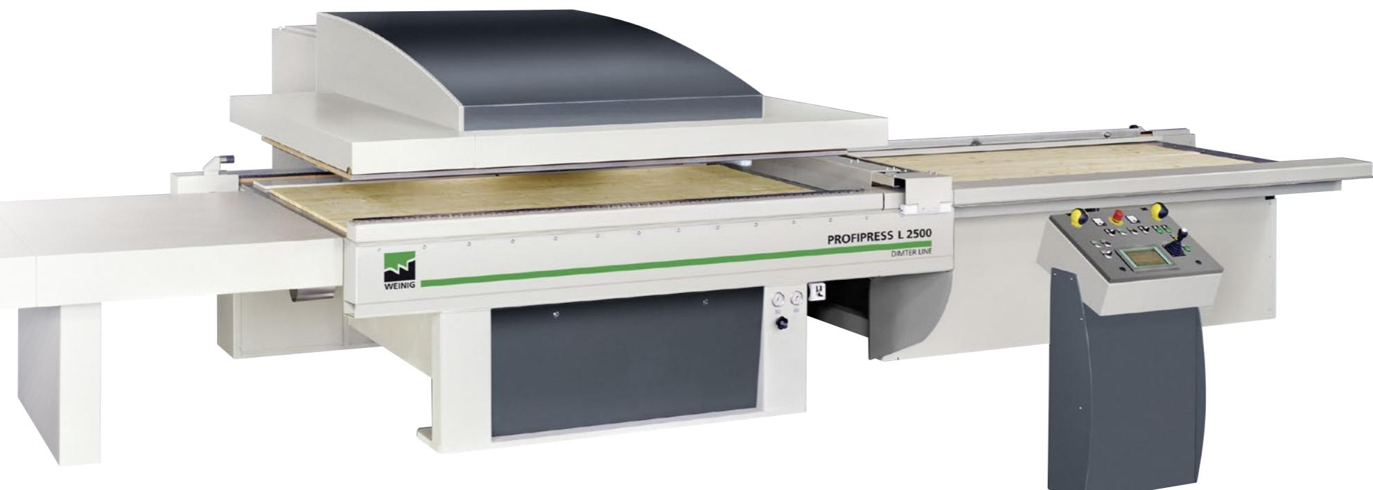
Tiempo de ajuste extremadamente corto. Tiempos de prensado cortos y un endurecimiento muy rápido permiten una gran cantidad de material de salida. Juntas exactas, completamente cerradas y superficies planas representan la calidad de WEINIG. Por la nueva técnica de encolado se pueden ahorrar costos.
