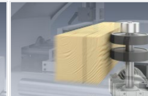
Frequenz geregelter, stufenloser Vorschub 5 - 40 m/min
