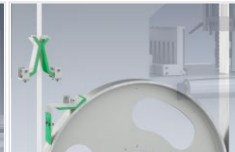
Automatische Reinigung und Schmierung des Bandsägeblatts und beider Bandräder
