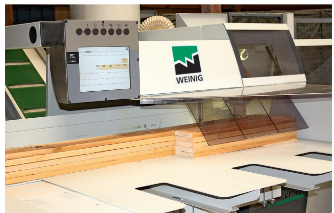
Im Einsatz: Optimierungskappsäge in Kombination mit der OptiPal-Software, links im Bild der Auslaufmonitor
