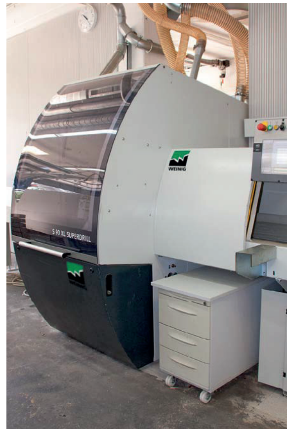
Kappen, bohren, fräsen in einem Durchgang – die OptiCut S90 XL Superdrill von Dimter macht's möglich
